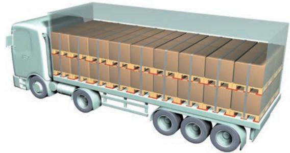
Korrekte Ladungssicherung: Die Antirutschmatten sind hier rot markiert.
