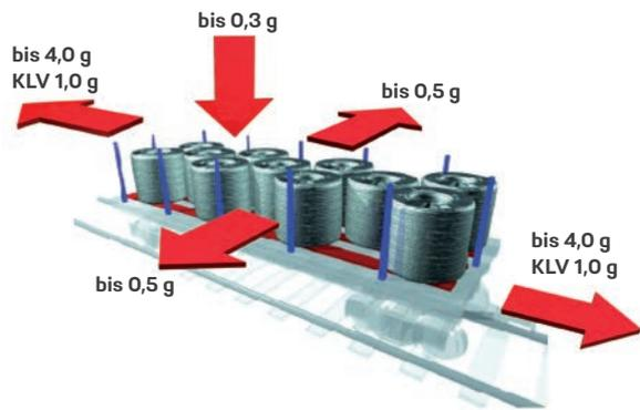
Bei Bahntransporten sind die Kräfte extrem: Die Ladungssicherung muss das Vierfache des Ladungsgewichts aushalten (KLV = Kombiniertes Ladungsverkehr).
