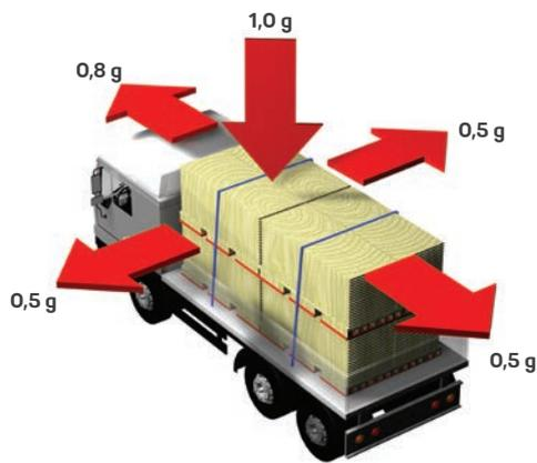
80% des Ladungsgewichts müssen bei Fahrmanövern von LKW durch Ladungssicherung aufgefangen werden.
